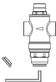
La taratura finale del riduttore di pressione deve essere eseguita a circuito idraulico completamente pieno e con tutti gli utilizzatori chiusi, diversamente si avrebbero dei valori falsati dal fatto che, durante l'eventuale erogazione, la pressione a valle diminuisce in relazione alla quantità di flusso occorrente. La taratura del riduttore di pressione si esegue agendo sulla ghiera interna, avvitando in senso orario per aumentarne il valore, svitando in senso antiorario per diminuirlo.
