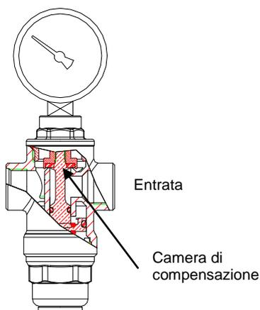
Quando le utenze da servire sono chiuse, la pressione a valle aumenta spingendo il pistone del riduttore verso il basso. In questo modo l'otturatore chiude la sezione di passaggio del riduttore mantenendo costante la pressione al valore di taratura, impostato sulla molla; la minima differenza di pressione esistente a cavallo dell'otturatore consente, infatti, la perfetta chiusura di quest'ultimo.
