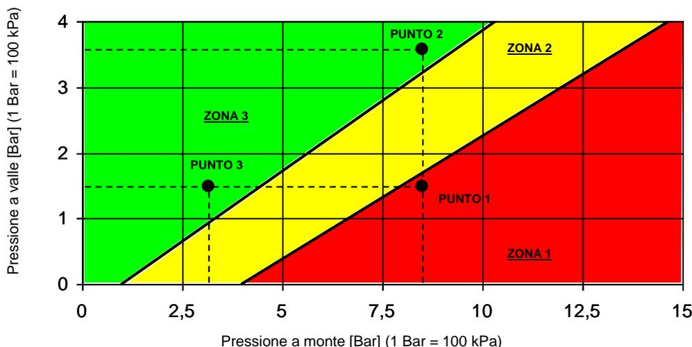
Per non incorrere in fenomeni di cavitazione e quindi di eccessiva rumorosità del componente, è consigliato dimensionare il numero di riduttori di pressioni necessari per un certo salto di pressione secondo quanto descritto nel "DIAGRAMMA DI CAVITAZIONE".
